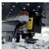
Deska s uhlíkovými kartáči pro pevný zemní bod
